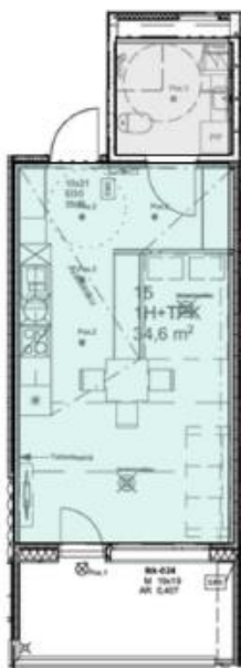
Bild 11. Exempelmodul från Lakeas Sydänpuu. Våtutrymmen markerad i grått längst upp till höger.
