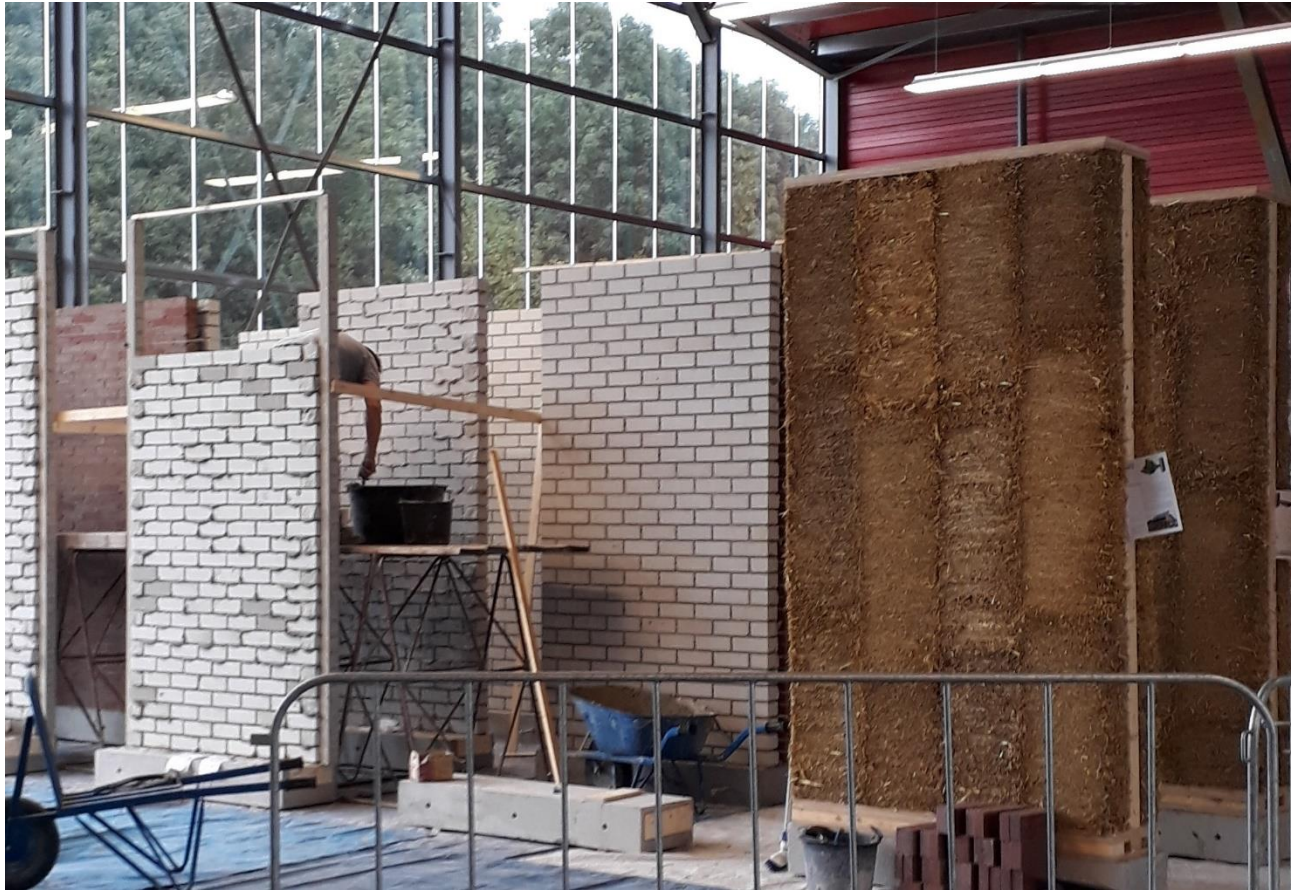
Picture 3. TNO on testaamassa erilaisia kierrätetystä materiaalista tehtyjä seinäelementtejä. (Kuva Virpi Palomäki, CE Wood -project).
