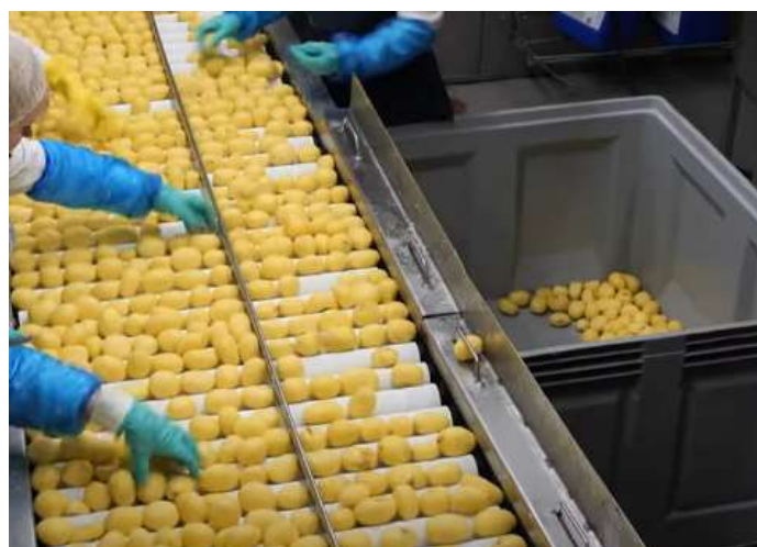
Figur 11. Kvalitetssortering efter skalning vid ett företag som förädlar potatisprodukter. Stillbild från video (Visit Kristinestad, 2023).
