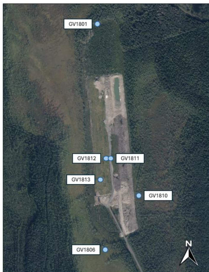
Figur 3.4. Karta över Dåva Norra området, inklusive placeringen av de grundvattenrör som provtas två gånger per år. Vattenflödet är uppmätt att flöda från norr till söder, där punkten "GV1801" är "uppströms" och punkterna "GV1810" och "GV1806" är "nedströms".
