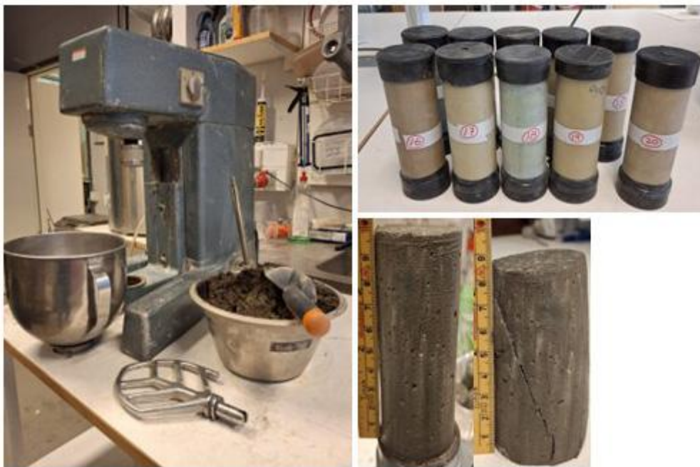
Figur 5.2. Provberedning i laboratorium. Blandning av jord och bindemedel (till vänster). Provtuber (till höger, över) som trycks för mätning av hållfasthet (till höger, under). Foto: Ramesh Kumar Thakur.
