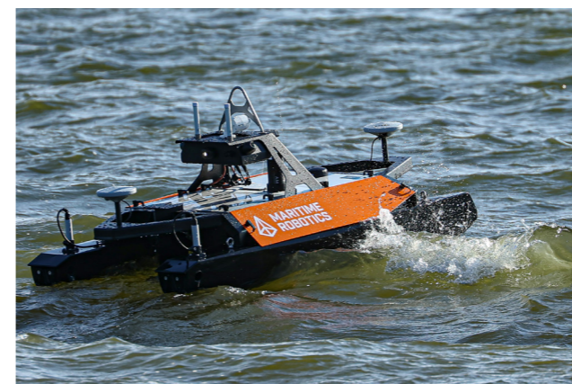
▲ Novias vattendronare ger högprecision i bottenmätningar för utbildning och projekt. Foto: Anders Borg
