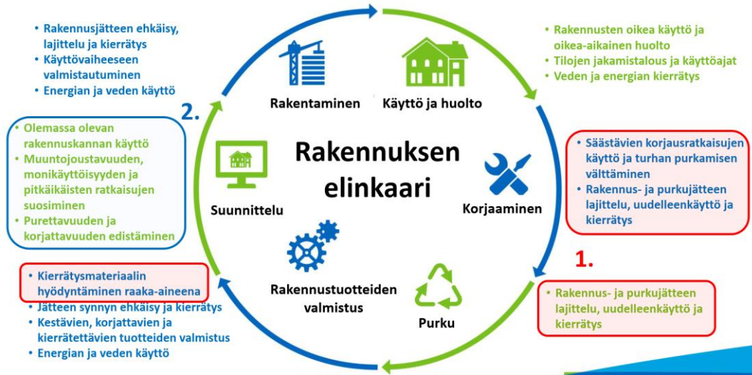
Kuva 2. Kiertotalouden edistäminen rakennuksen elinkaaren aikana yliarkkitehti Harri Hakasten seminaarissa esittämän kaavion mukaan.
